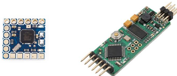
Şekil 14. Örnek OSD modülleri görüntüsü.
