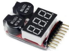
Şekil 16. Örnek LiPo batarya alarm görüntüsü.
